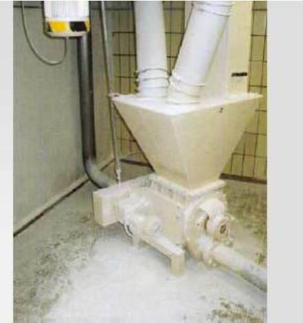
Strati di polvere alimentare su trasporto pneumatico (P, S)
